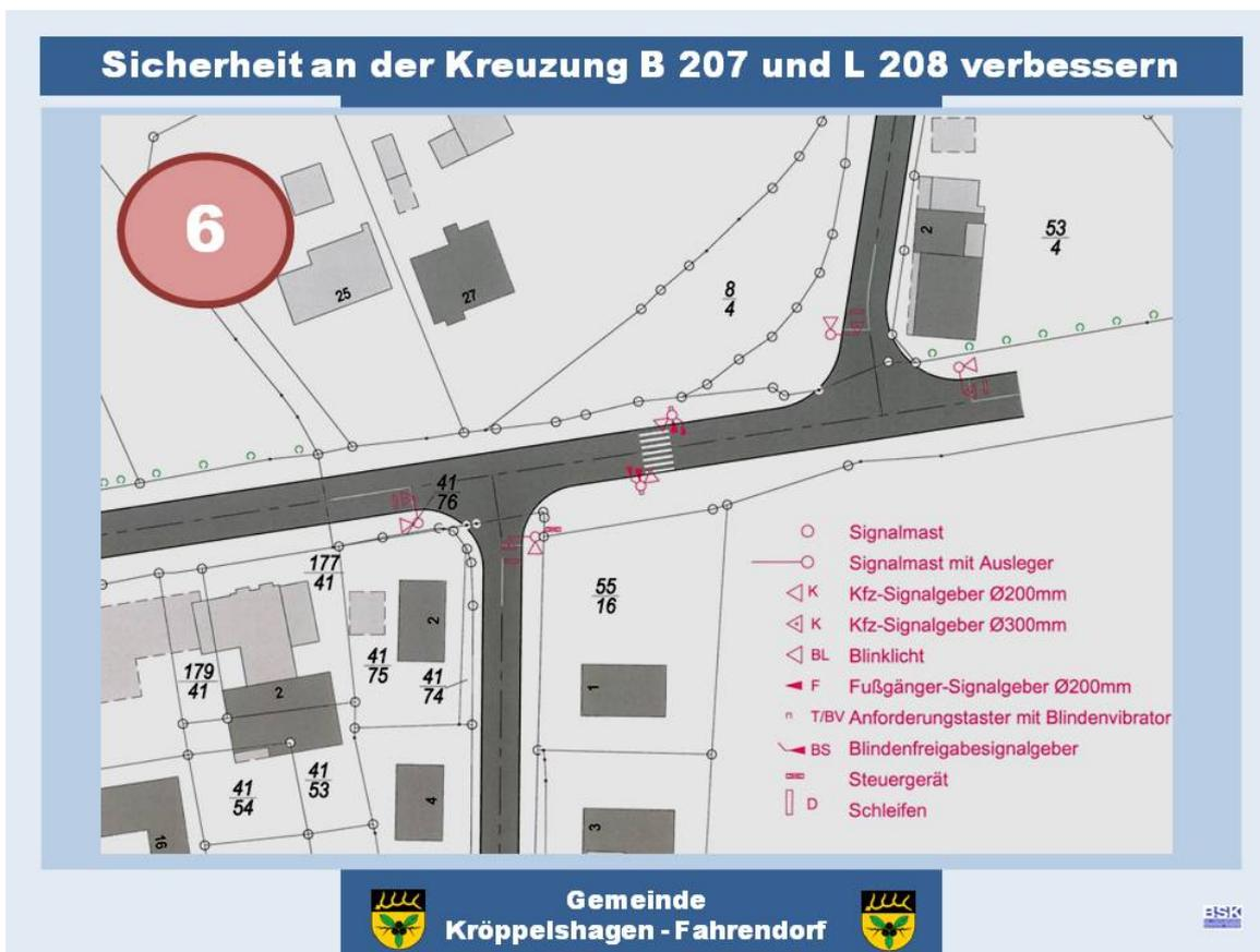
Die Lichtzeichenanlage würde über befahrbare Induktionsschleifen mit einem entsprechenden Programm so gesteuert, dass in der Regel aufgrund der Verkehrsmengen der Verkehrsfluss auf der B 207 Vorrang haben wird.
