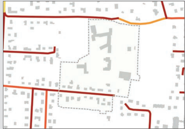
Abb. 31: Wärmeliniendichte im Fokusbereich, AQ 100%
