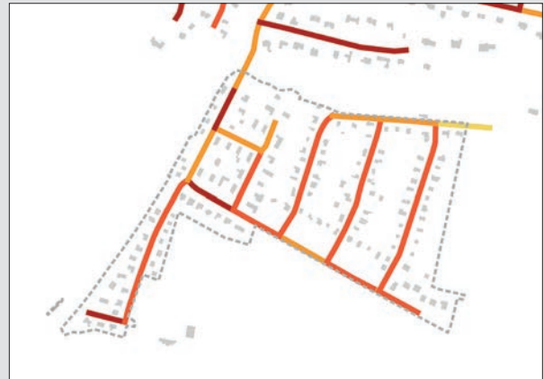
Abb. 31: Wärmelinienichte im Fokusbereich II, AQ 100%
