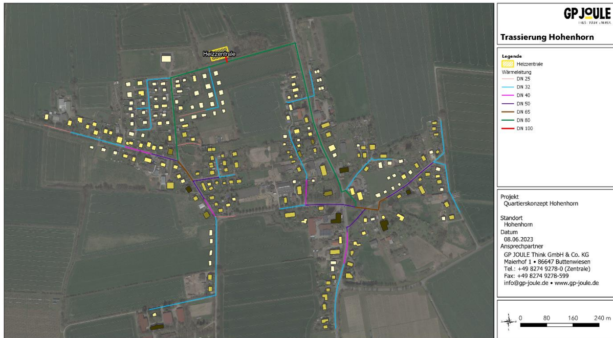
Abbildung 32: Dimensionierung eines möglichen Wärmenetzes der Gemeinde Hohenhorn
