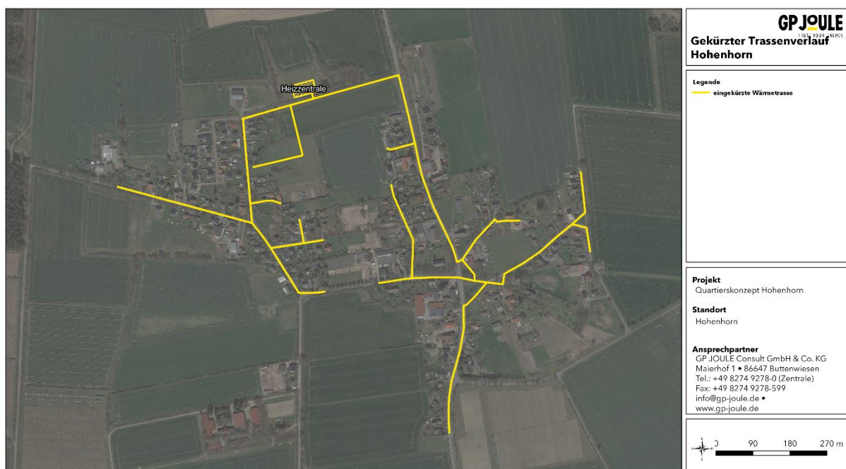
Abbildung 45: Trassenverlauf eines gekürzten Wärmenetzes
