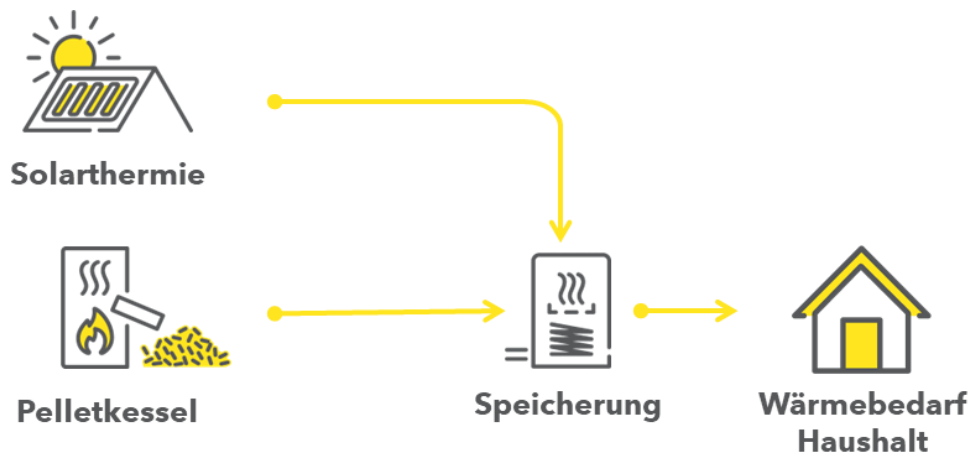
Abbildung 29: Schematische Darstellung Pelletheizung + Solarthermie
